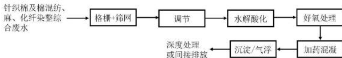
图 7-3 针织棉及棉混纺染整、麻染整以及化纤染整的综合废水常规处理工艺流程图
